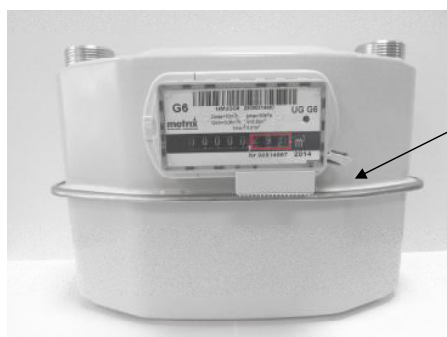
Фотография общего вида счетчика с указанием места пломбировки
